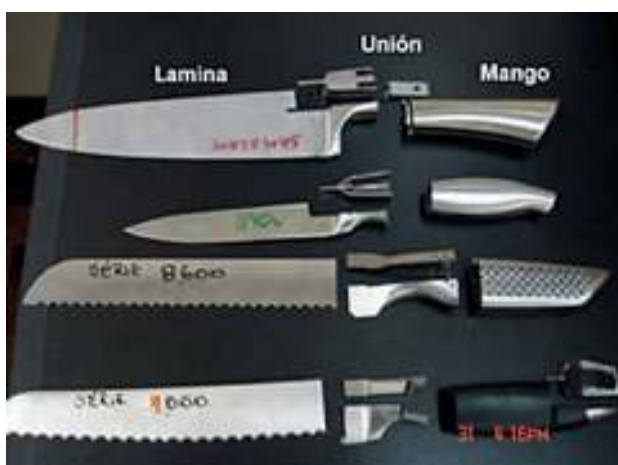
Figura 1. Cuchillos en despiece. Se dividieron en 3 partes: láminas, uniones y mangos Fuente: Elaboración propia.
