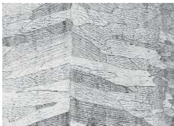
Figura 8. Microfotografía de la sección longitudinal del metal fundido. Aumento: 50x. Ataque: Kalling II. Fuente: Elaboración propia.
