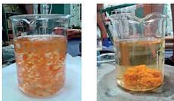
Figura 5. Clarificación por coagulación – floculación.
