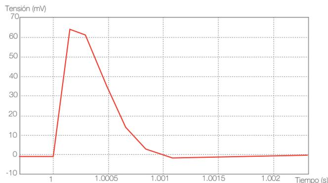
Figura 8. Corriente del motor expresada sentido indirectamente como tensión.
