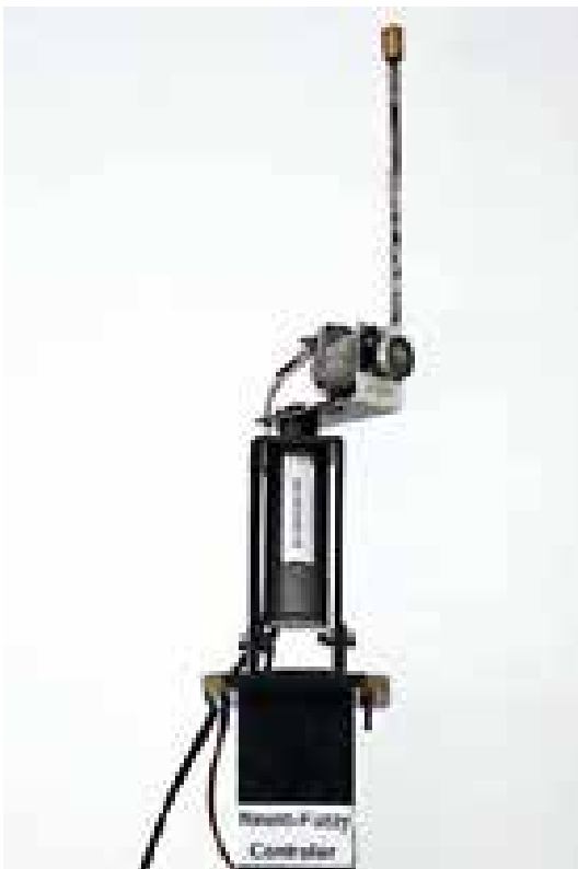
Figura 7. Péndulo invertido rotacional. Fuente: Elaboración propia.
