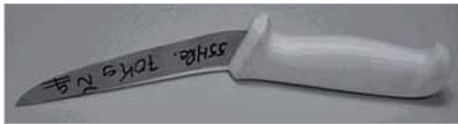
Figura 1. Lámina de cuchillo luego de ensayo de flexión. Fuente: Elaboración propia.
