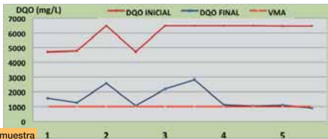
Gráfica 2. Tratamiento de efluente con DQO inicial < 7,000 mg/L mediante Fenton simple y Fenton térmico activado. Fuente: Elaboración propia.
